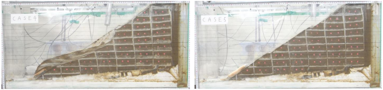
図-6(d) ケース4の変形状況
