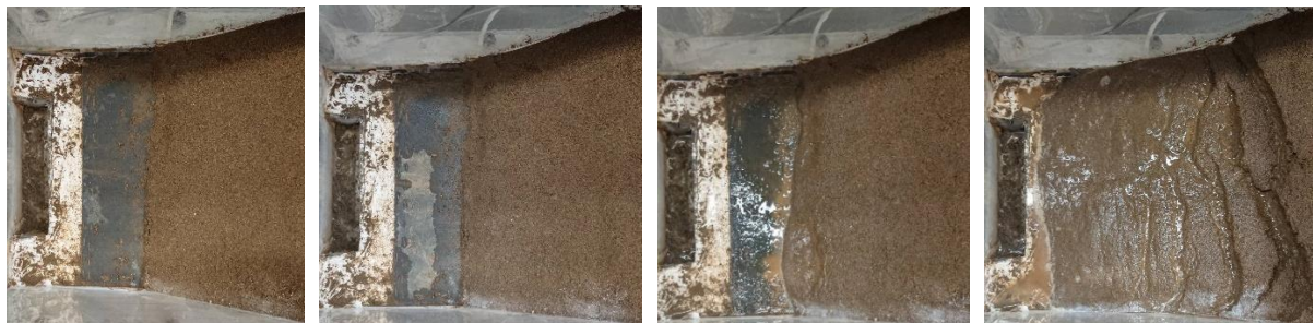
図-8 ケース1の法尻部における浸透破壊 (左から、浸透開始後0, 60, 75, 90分経過時)
